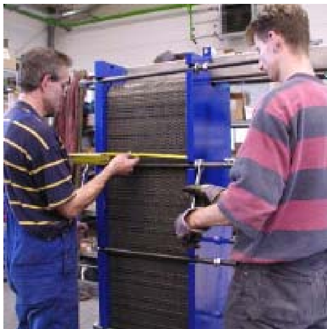
Рис 10/2: Правильный порядок вскрытия ПТО с контролем допустимого перекося нажимной плиты.
